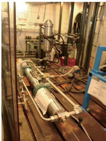
写真 5 油圧・水圧複合システム
