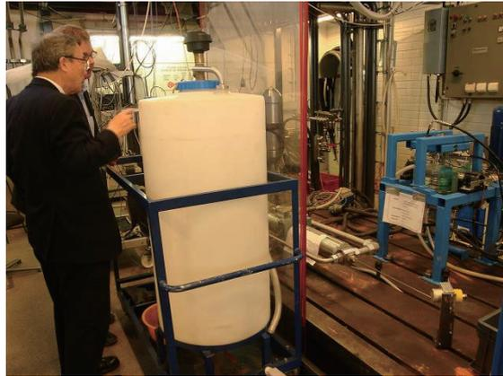
写真 4 斜板式水圧ポンプの実験・計測
