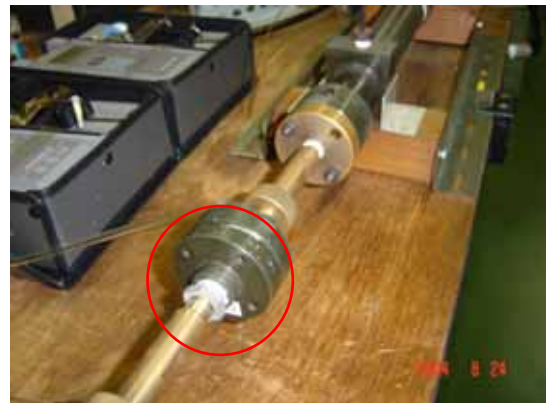
図 1.1.2 固定オリフィスの試験回路
