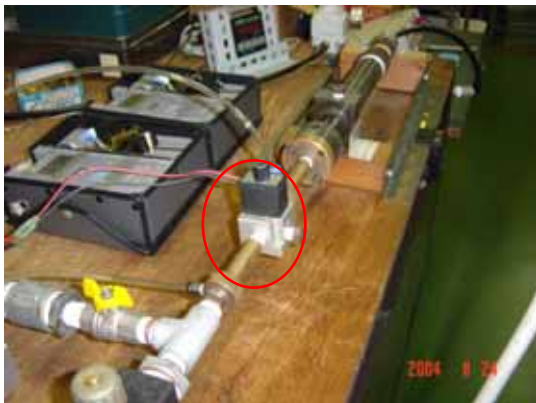
図 1.1.1 電磁弁の試験回路
