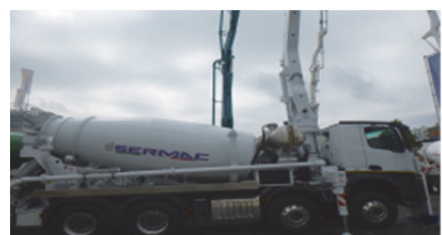
コンクリートポンプとミキサー車が一体の車輛
