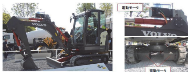
VOLVO 社製フル電動小型ショベル EX2
