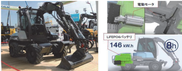
MECALAC 社製電動油圧式ホイールショベル e12
