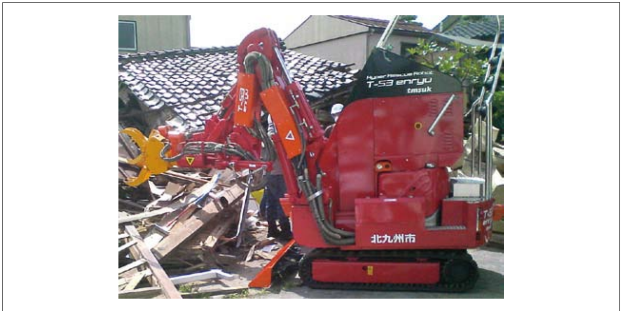
図 56 油圧レスキュー双腕ロボット『援竜』
