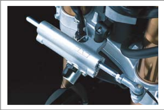
図 10 二輪車用電子制御式ステアリングダンパ
