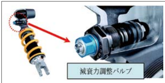
図8 減衰力調整バルブ付リヤサスペンション
