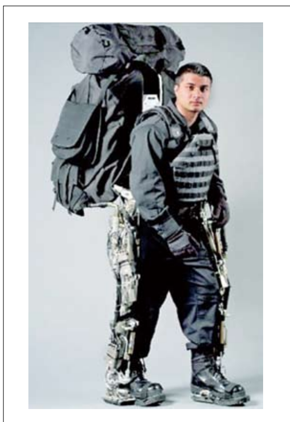
図 57 油圧パワーアシスト装置 BLEEX
