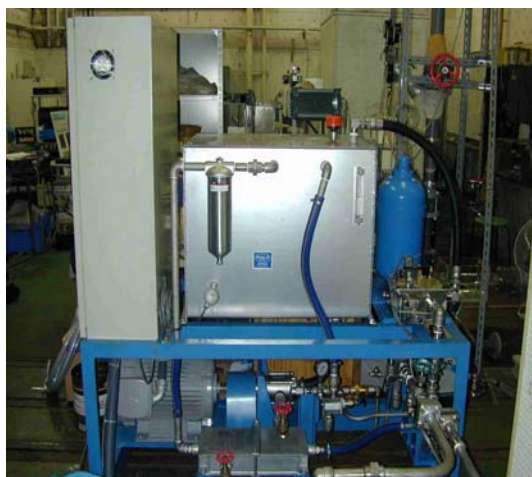
(a) アクアドライブユニット 30cm 3 /rev ピストンポンプ+15kW 電動機
