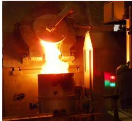
注湯：溶けた鉄を鑄型に流し込む
